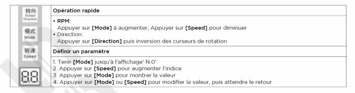
• Après la mise sous tension, les curseurs de rotation s'affichent. Lorsqu'on entre en mode paramétrage, il affiche l'index ou la valeur du paramètre. Une fois le paramètre réglé, les curseurs de rotation s'affichent automatiquement.
